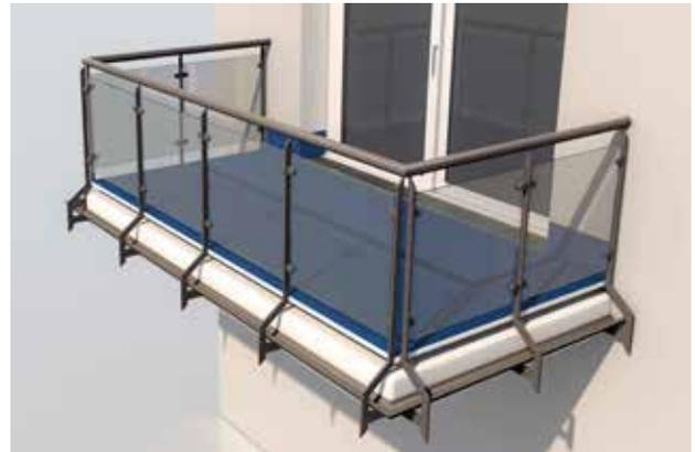
**Geeignete Abdichtungsstoffe müssen nach DIN EN 14891: 2013-07, Tabelle 3 geprüft und gekennzeichnet sein und mindestens der Klasse O1 oder O1P entsprechen.**
